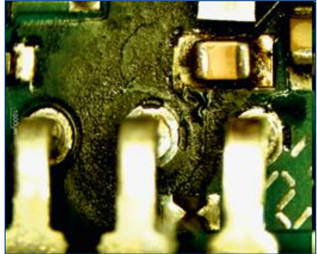
Elektromigration an einer elektronischen Baugruppe (Source: AUCOTEAM GmbH)
