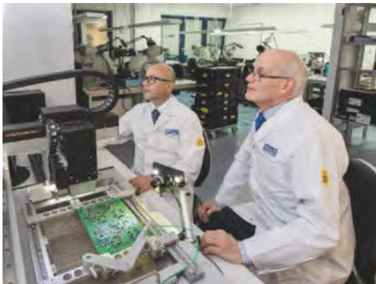
Automatisiertes Reworken mit Ersa HR 600/2.
